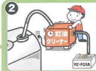
2 大型ストレーナーで 小サビ・ドロを除去
